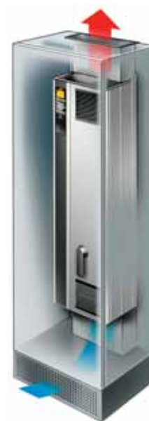
Специальный набор позволяет устанавливать преобразователи частоты с исполнением корпуса D1 и D2 в шкафах Rittal, что позволяет удалять более 85% выделяемого тепла без контакта обдувающего воздуха с электроникой
