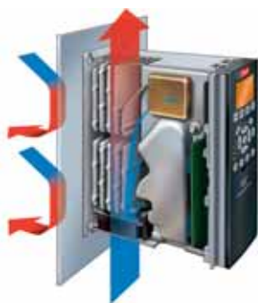
Установка на стене с принудительным охлаждением через радиатор
