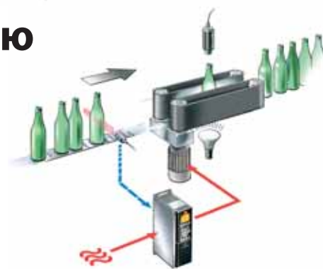
Бутылка находится под наблюдением камеры, в определенный момент активирующей вспышку. AutomationDrive обеспечивает регулирование скорости на всем протяжении производственной линии.
